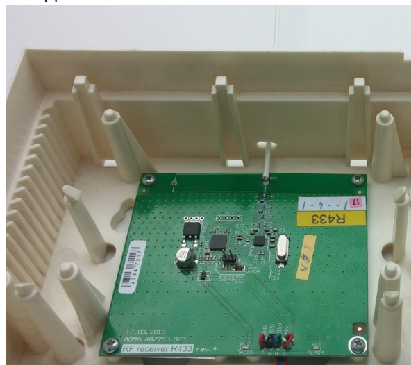
Рисунок 22. Радиоприемник «P433» rev.4 с антенной в корпусе прибора
