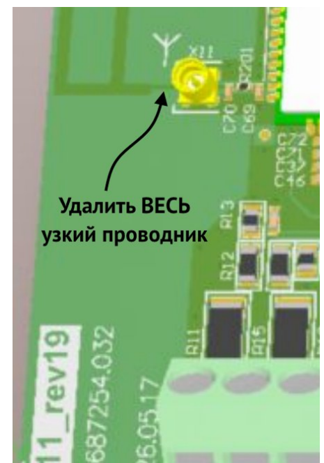
Рисунок 6. Подготовка платы ревизии 19 для подключения внешней антенны
